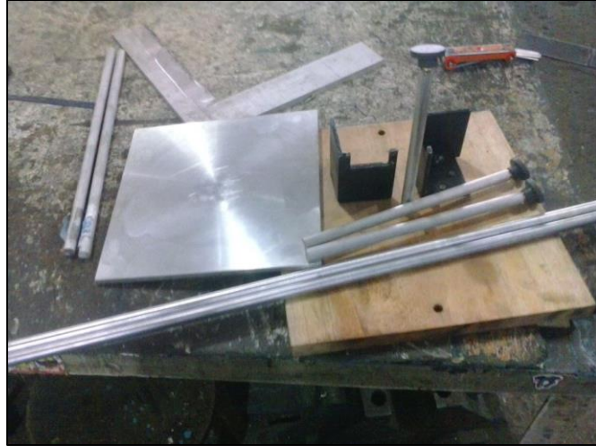
Figura 6. Piezas maquinadas que conforman el sistema bola en placa.
