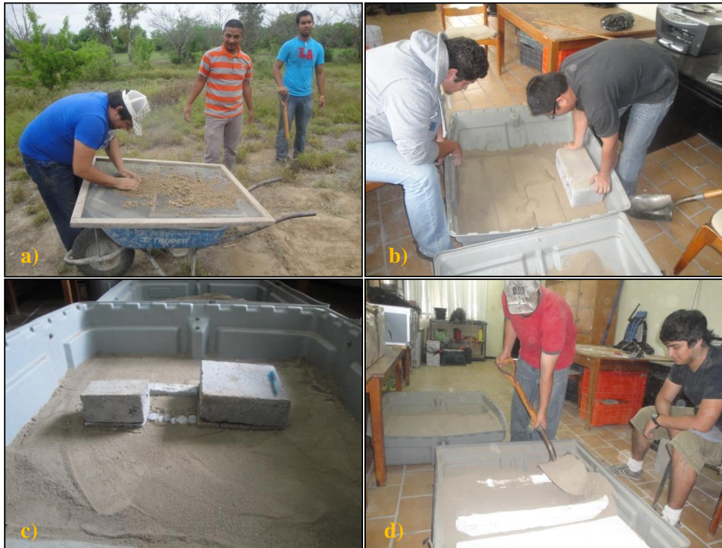
Figura 3. Elaboración del modelo de estudio para la zona arqueológica. a) Selección del sedimento, b) compactación del material seleccionado, c) posicionamiento de las estructuras, y d) recubrimiento de las estructuras y compactación
