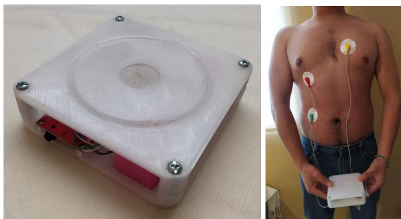
Figura 15. Prototipo ECG con cubierta de PETG y electrodos. Fuente: Elaboración Propia
