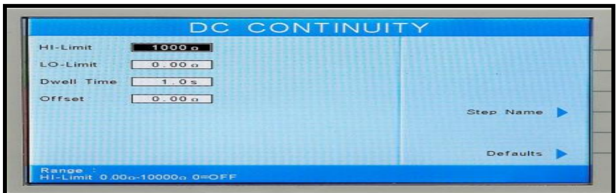
Figura 9 Parámetros de Prueba para DC Continuity
