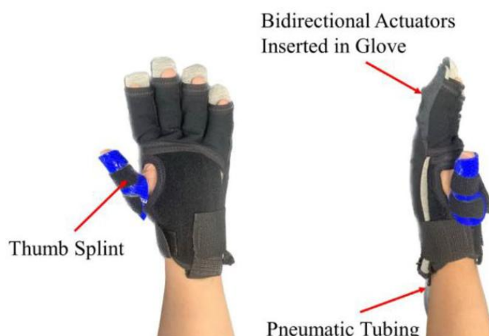
Figura 1. Guante robótico, SR Glove, con accionamiento neumático
