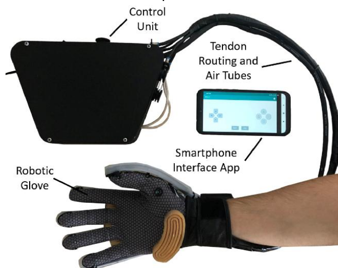
Figura 3. Guante robótico con capacidad de abducción en cada dedo.
