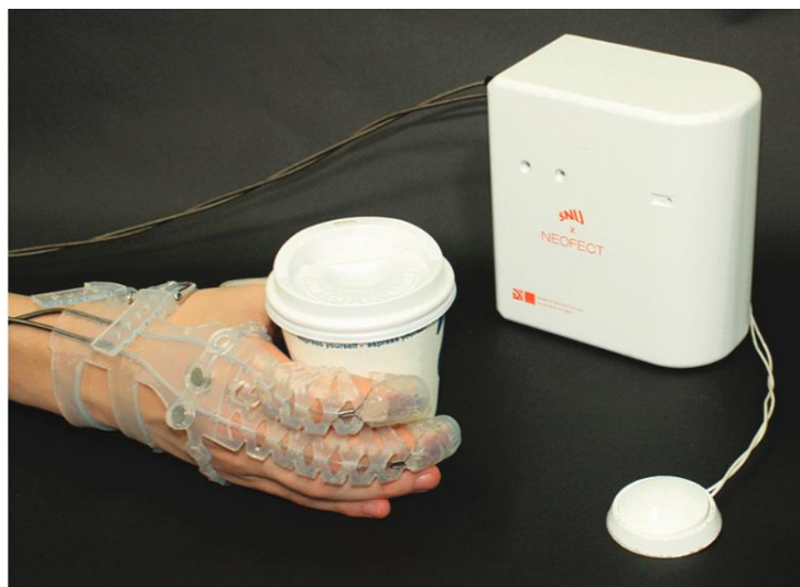
Figura 2. Exo Glove Poly II con accionamiento por cable.
