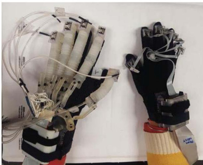
Figura 5. Guante robótico bilateral para terapia espejo
