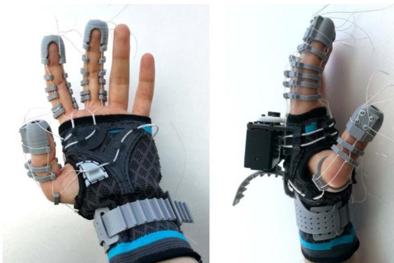
Figura 4. Guante robótico accionado por cable y validado con FEM.
