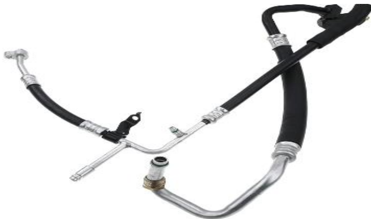
Figura No. 2: Manguera de montaje de línea de succión y descarga de sistema de refrigeración Ford E-350 Econoline 2007
