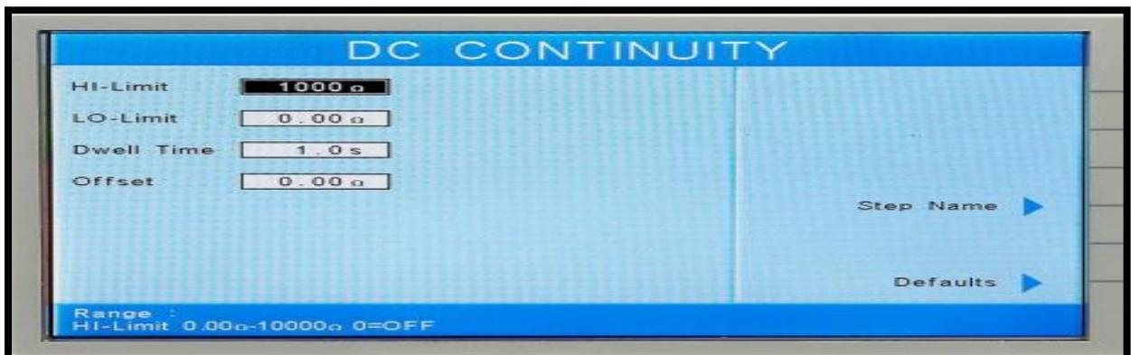
**Nota.** Ilustración representativa de los parámetros configurables para la prueba de DC Continuity. Tomado del Manual de Servicio y Operación del OMNIA II [Fotografía] Associated Research, 2024, [https://par.arisafety.com/ar\\_omnia\\_manual](https://par.arisafety.com/ar_omnia_manual).
