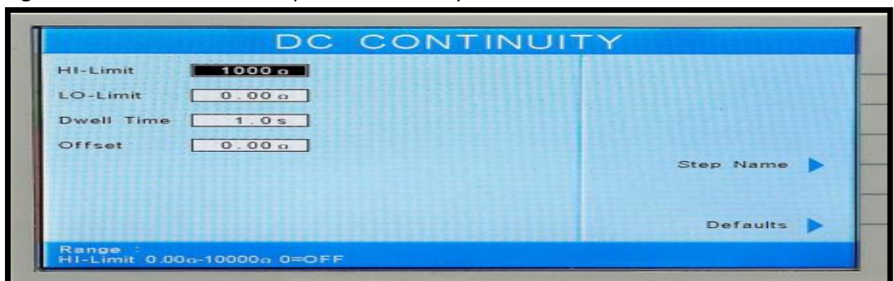
Figura 9 Parámetros de Prueba para DC Continuity
